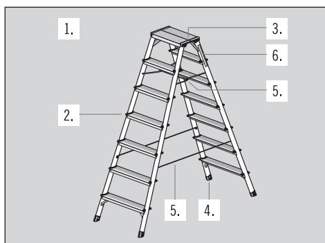
Durante l'ispezione regolare della scala occorre tenere conto dei punti di controllo 1.-6.
