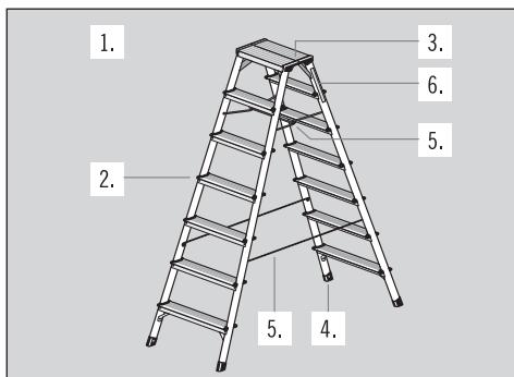
În timpul inspecției regulate a scării cu treptetrebuiu luate în considerare punctele de verificare 1. - 6.
